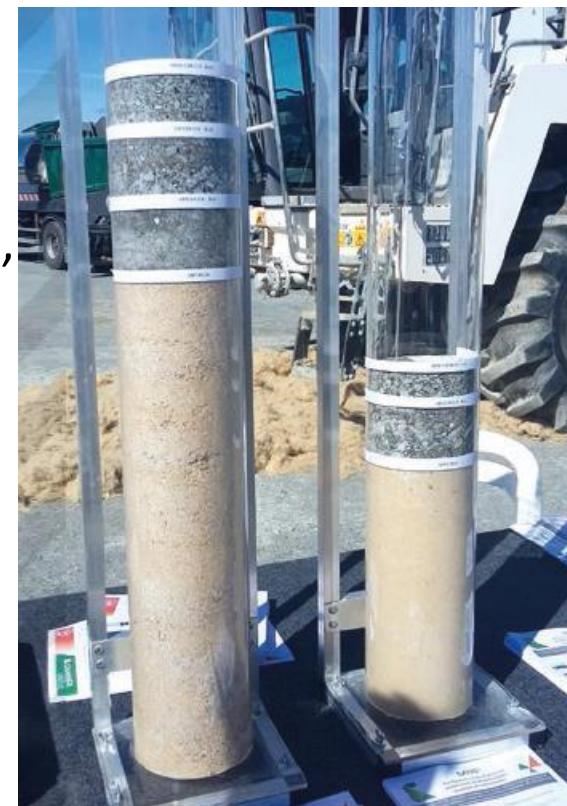
Epaisseurs couche de forme : - GNT = 0,50 m (à gauche) - Sol traité = 0,35 m (à droite)
