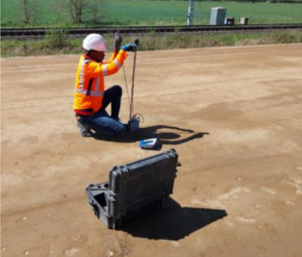
↑ Contrôle de compactage au pénétromètre dynamique léger à énergie variable Panda.
