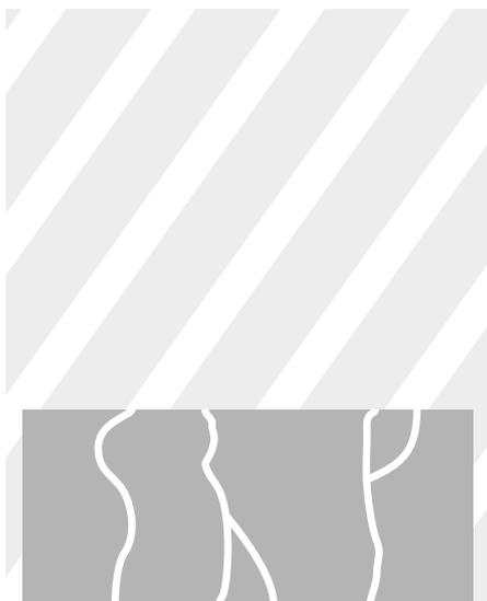
▲ Figure 1. Schéma illustrant le comportement d'un revêtement en béton exécuté sans armatures longitudinales et sans joints de retrait transversaux. Conséquences : fissuration large, anarchique et aléatoire.
