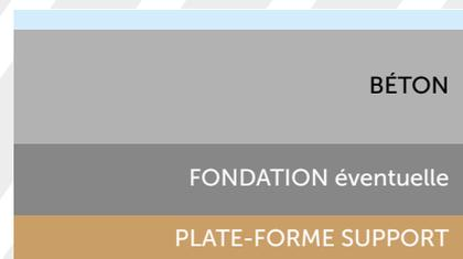
↑ Coupe en travers-type d'une structure de voirie ou d'un aménagement urbain en béton.
