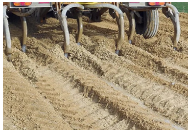
L'utilisation d'une arroseuse dotée d'un enfouisseur permet une meilleure répartition transversale de l'eau dans le sol.
