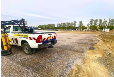
Contrôle à la dynaplaque de la portance de la CDF traitée. © Medinger & Fils
