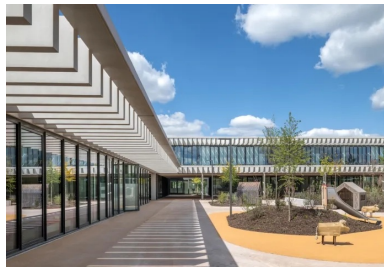
Dans l'enceinte de l'école, comme en périphérie, le bâtiment est entièrement cerné par des ombrières de béton brut lissuré.
