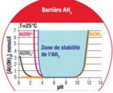
Figure 2 : Zone de stabilité de l'alumine hydratée AH3
