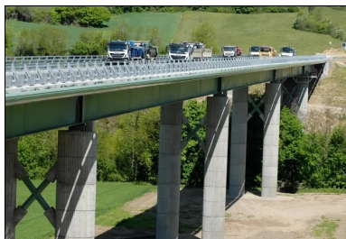
Épreuves de chargement du viaduc. Cette étape classique et obligatoire de la construction d'un ouvrage d'art consiste à vérifier que celui-ci est bien apte à assurer sa destination finale en termes de portance. Pour cela, un certain nombre de camions, dont le poids et la répartition sont calibrés, sont positionnés sur le tablier. Les flèches induites sur le tablier sont alors mesurées et comparées aux flèches théoriques attendues. ©DREAL Occitanie
