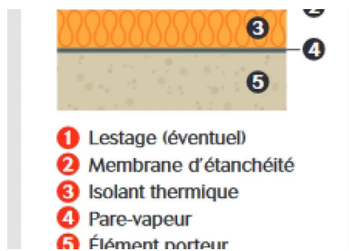
TT - Structure d'une toiture "chaude" Fig.1
