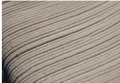
Impression 3D béton par dépôt de couches successives
