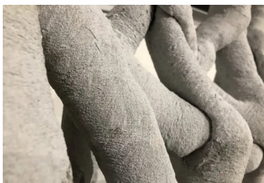
Béton imprimé en 3D - Soliquid
