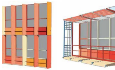
Détails des modules de façade nord et est (à gauche), sud et ouest (à droite).
