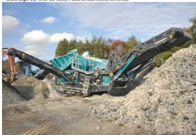
Concassage du béton sur le site
