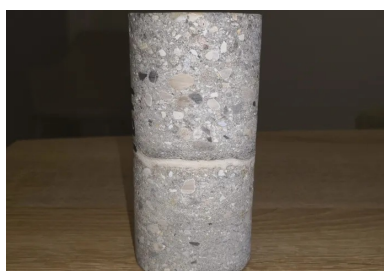
Éprouvette de béton intégrant la membrane SEPC.
