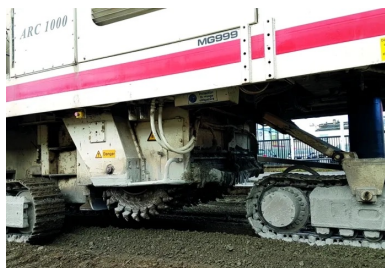
En plus de son rotor de 2 m de largeur avec 224 dents, l'ARC 1000® est équipé d'une lame flottante pour assurer le nivellement du fond de forme, d'un malaxeur, d'une vis de répartition et d'une lame de repandage. Outre la précision des dosages, l'homogénéité transversale et verticale du traitement est assurée par un malaxeur de centrale puissant.
